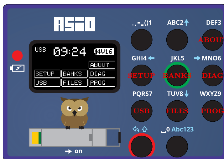
Rys. 7: Przyciski odpowiadające kafelkom menu
