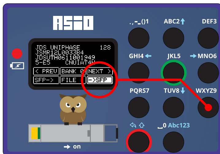
Rys. 5: Programowanie wkładki zawartością pamięci banku (klawisz 9)
