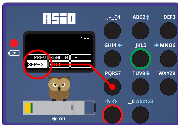
Rys. 4: Ładowanie danych wkładki do pamięci banku (klawisz 7)
