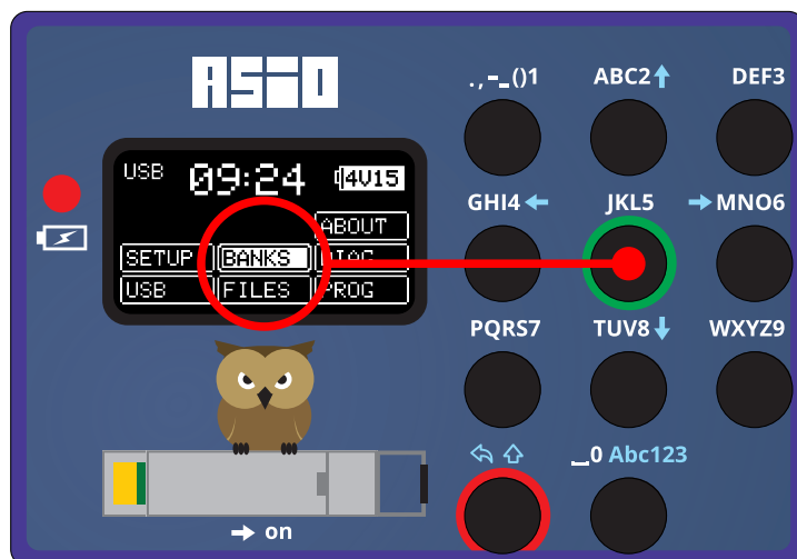
Rys. 3: Wybór menu „BANKS” za pomocą klawisza 5
